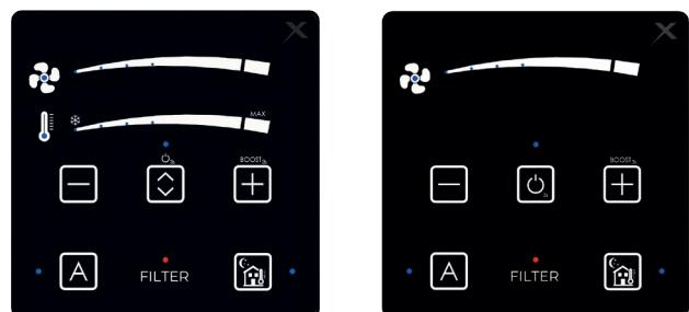
INTEGRIERTES TOUCHPANEL ZUR STEUERUNG VON LÜFTUNG UND ELEKTRISCHER HEIZLEISTUNG SOWIE ZUR AUSWAHL DER BETRIEBSART
