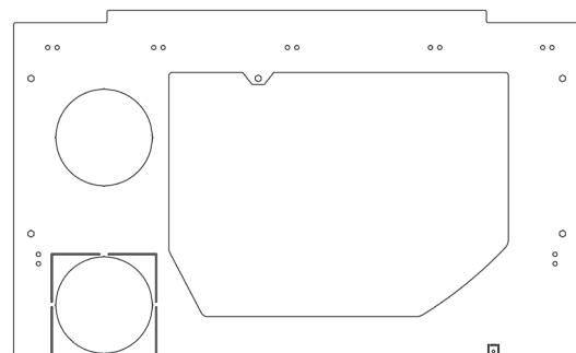
DIE MITGELIEFERTE MONTAGEPLATTE AUS METALL MIT VORGABE DER ÖFFNUNGEN FÜR ZU- UND ABLUFT SOWIE INTEGRIERTE STEHBOLZEN ZUR GERÄTEAUFPENDUNG SORGT FÜR EINE EINFACHE INSTALLATION
